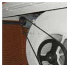
GRUPO DE TRANSMISION CON VENTILADOR CENTRIFUGO EN ACERO GALVANIZADO.
