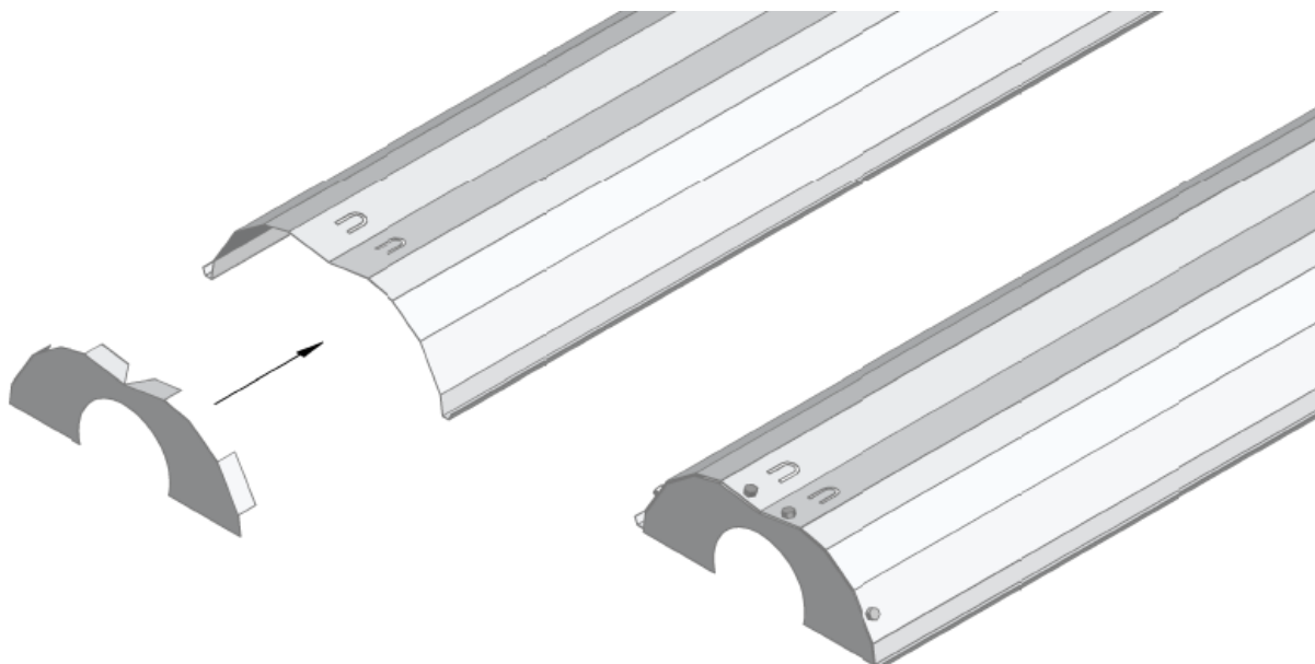
9.ábra: Ernyő végelem felszerelés
