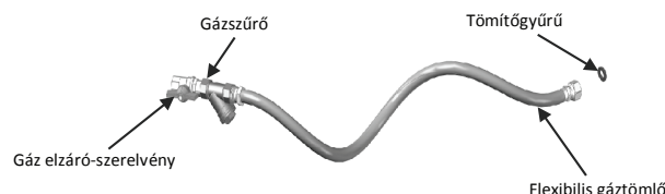
13. ábra: Csatlakoztatás flexibilis tömlővel (opció, a készülék gyártónál megvásárolható)
